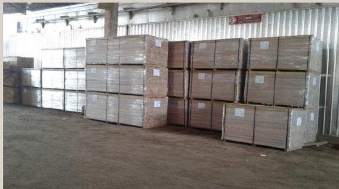
Toda la madera ha pasado por un proceso de secado en cámaras con controles automáticos, garantizando que todas las piezas salgan con una humedad uniforme de un 10%, humedad esta que se incrementara en el transporte marítimo dentro de container a un 14%.
